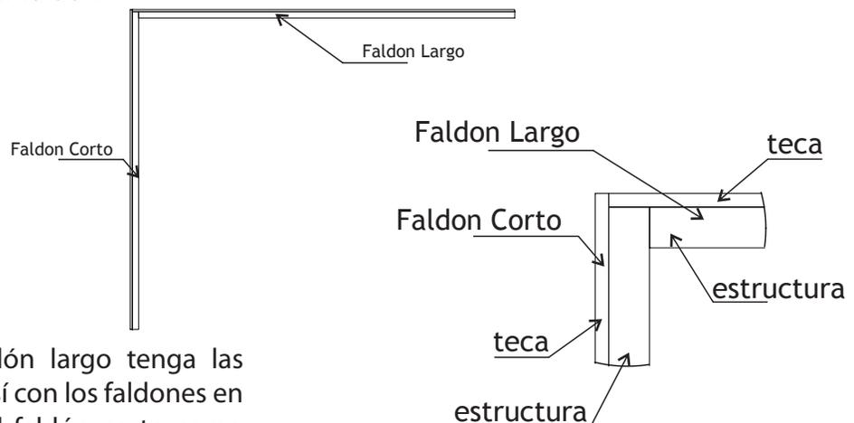
Verifique que la estructura del faldón largo tenga las perforaciones de iniciado, de no ser así con los faldones en posición, utilice las perforaciones del faldón corto como guía para realizarlas en la estructura. Y a continuación asegure con los tornillos.
